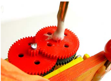
Abb. 195 | Leimsicherung Sekundenkleber für Kunststoffe
