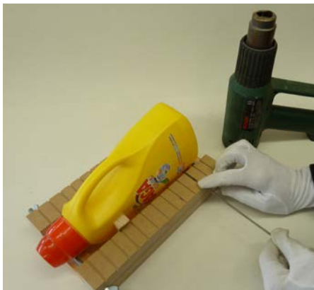
Abb. 189 | Einklemmen des unregelmässigen Behältnisses mit Keilen.
