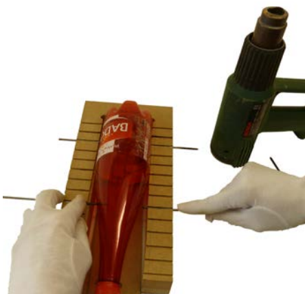
Abb. 190 | Hilfsgerät Achsmontage starr für PET-Flaschen (Bezug www.do-it-werkstatt.ch )
