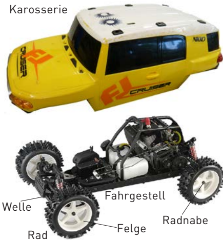
Abb. 178 | Karosserie und Fachbegriffe zum Fahrgestell
