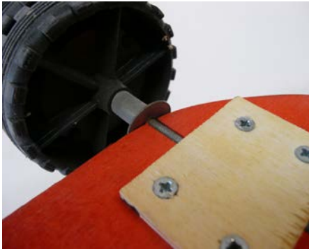
Abb. 180 | Achse im genuteten Brett und Abstandhalter durch einen Kunststoffrohrabschnitt
