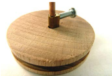
Abb. 207 | Fester Sitz auf Welle mit eingeklebtem Lüsterklemmeneinsatz
