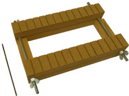
Abb. 188 | Hilfsgerät Achsmontage mit einstellbarer Breite
