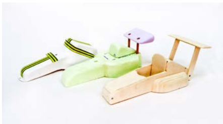
Abb. 175 | Karosserieentwicklungen mit Polystyrol (tiefgezogen), Polystyrolschaumstoff und Sperrholz
