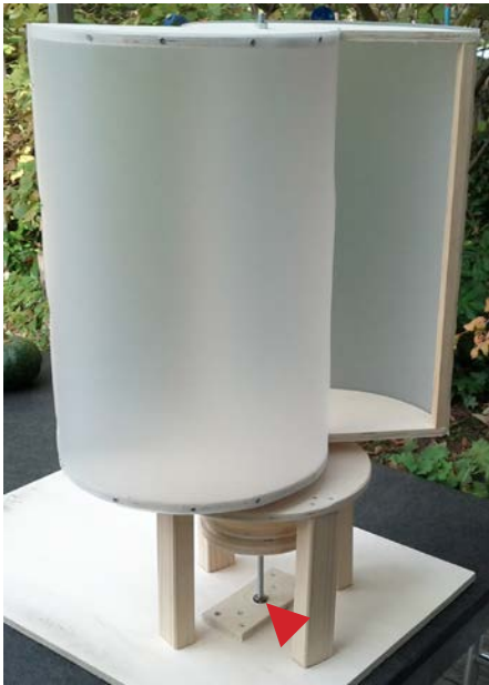
Abb. 274 | Savonius-Windrad mit Feststellschraube
