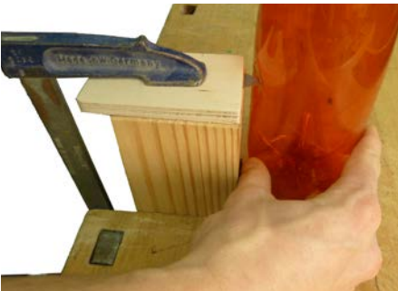
Abb. 282 | Flasche genau schneiden mithilfe einer eingespannten Klinge eines Universalmessers.
