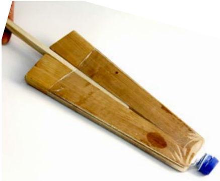
Abb. 268 | Schrumpfform mit Keil zum Spannen
