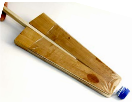
Abb. 283 | Flasche schrumpfen mittels Holzform und Heissluftföhn.
