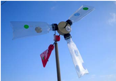
Abb. 269 | Windrad mit Holznabe
