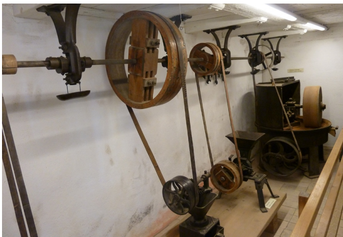
Abb. 248 | Riemenantriebe im Freilichtmuseum Ballenberg
