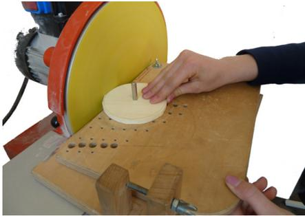
Abb. 155 | Schleifhilfe für Räder, geeignet für Holz- und Kunststoffräder aller Dicken (Bezug [www.do-it-werkstatt.ch](http://www.do-it-werkstatt.ch))
