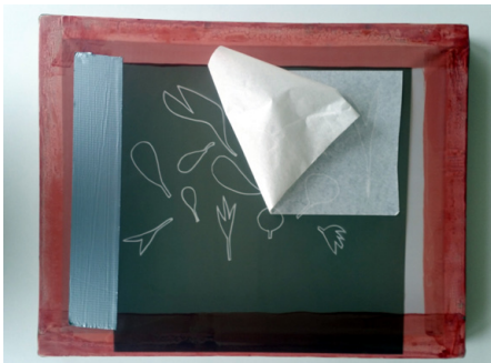
Abb. 48 | Unzusammenhängende Folienteile müssen mit einer Transferfolie auf das Sieb transportiert werden, damit sich die Abstände nicht verschieben.
