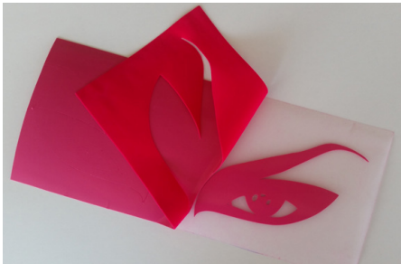
Abb. 57 | Der Plotter schneidet nur durch die Flockfolie und lässt die transparente Trägerfolie ganz. So behalten die einzelnen Teile auch nach dem Übertragen den richtigen Abstand.
