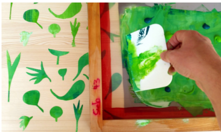
Abb. 47 | Mit einem Raker wird die Farbe durch die offenen Stellen gepresst.
