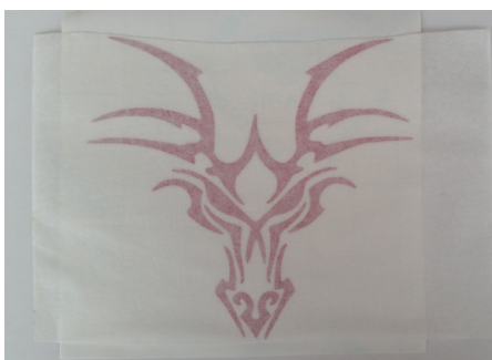
Abb. 73 | Die Transferfolie nimmt die einzelnen Teile gemeinsam mit. Sie ist leicht durchsichtig. Das erleichtert das genaue Platzieren des Motivs. Am gewünschten Ort lässt sich das Motiv andrücken. Anschliessend kann die Transferfolie entfernt werden.
