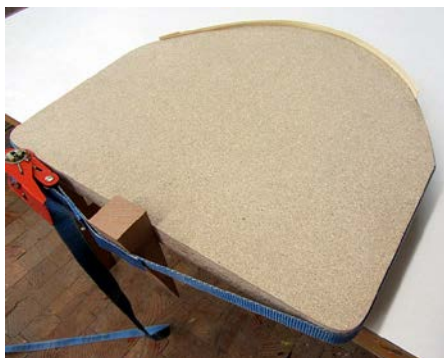
Abb. 171 | Einfache Lehre mit einem Spanngurt
