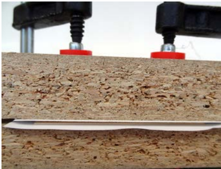
Abb. 170 | Die Schraubzwingen so positionieren, dass der Pressdruck direkt auf den verleimten Furnierblättern liegt.
