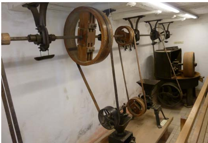
Abb. 248 | Riemenantriebe im Freilichtmuseum Ballenberg
