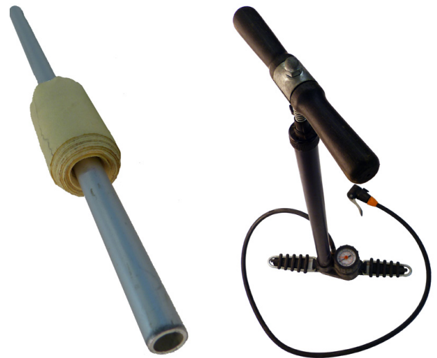
Abb. 252 | Der Zapfen und eine Standpumpe mit Druckanzeige
