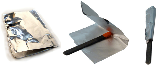
Abb. 251 | Hergang zur Herstellung der Zündholzrakete
