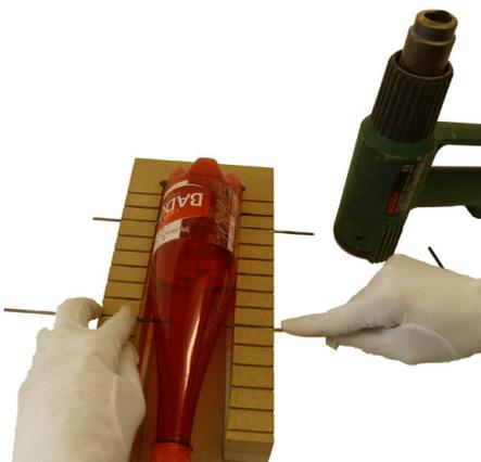
Abb. 190 | Hilfsgerät Achsmontage starr für PET-Flaschen (Bezug [www.do-it-werkstatt.ch](http://www.do-it-werkstatt.ch))
