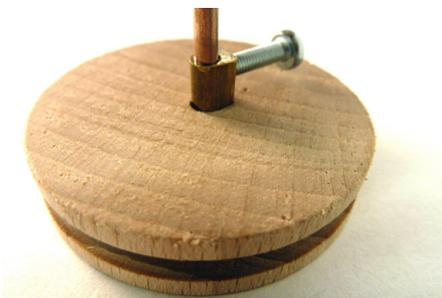
Abb. 207 | Fester Sitz auf Welle mit eingeklebtem Lüsterklemmeneinsatz
