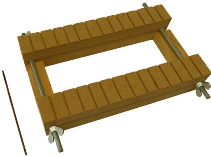
Abb. 188 | Hilfsgerät Achsmontage mit einstellbarer Breite
