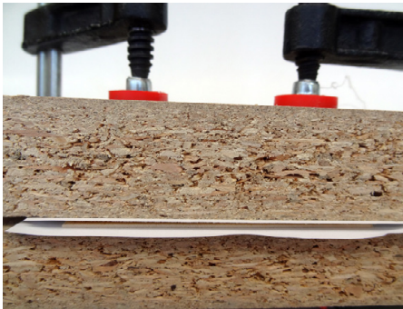
Abb. 170 | Die Schraubzwingen so positionieren, das der Pressdruck direkt auf den verleimten Furnierblättern liegt.
