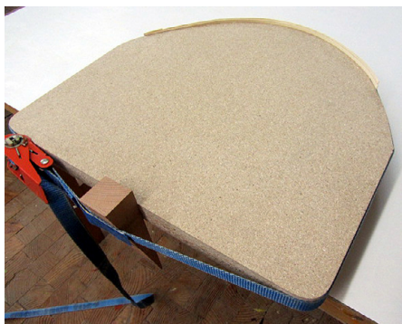
Abb. 171 | Einfache Lehre mit einem Spanngurt
