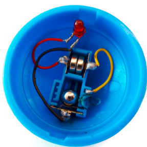
Abb. 139 | Analyse des Fliehkraftschalters eines Leuchtdiodenkreises
