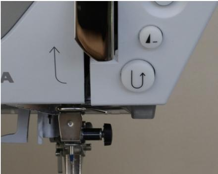
**Abb. 88** | Wird die Rückwärts-Taste lange gedrückt, so ist das Rückwärtsnähen eingeschaltet. Dazu erscheint im Display das entsprechende Zeichen. Um wieder vorwärts zu nähen muss die Rückwärts-Taste erneut lange gedrückt werden, bis das Zeichen im Display erlischt.
