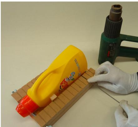
Abb. 189 | Einklemmen des unregelmässigen Behältnisses mit Keilen.
