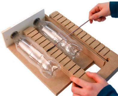
Abb. 198 | Hilfsmittel zum Stechen der Löcher bzw. Lager der Wellen (Plan Hilfsgerät Achsmontage)
