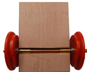
Abb. 250 | Beispiel einer Bauweise für Achsen
