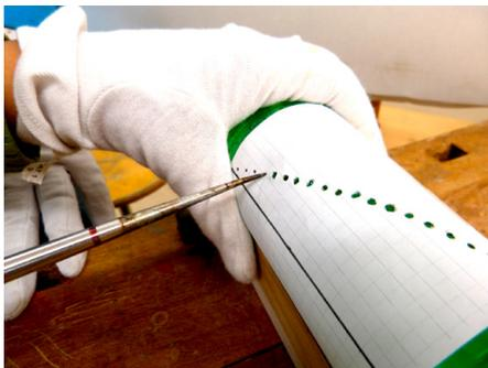
Abb. 271 | PET-Flasche mithilfe der Schablone und der erhitzten Ahle perforieren.
