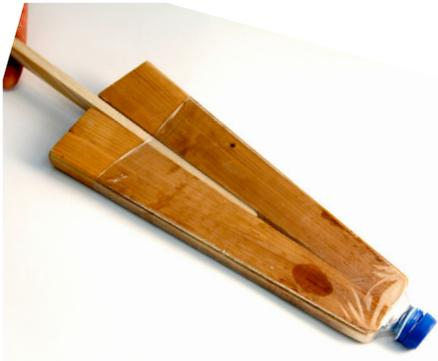
Abb. 268 | Schrumpfform mit Keil zum Spannen
