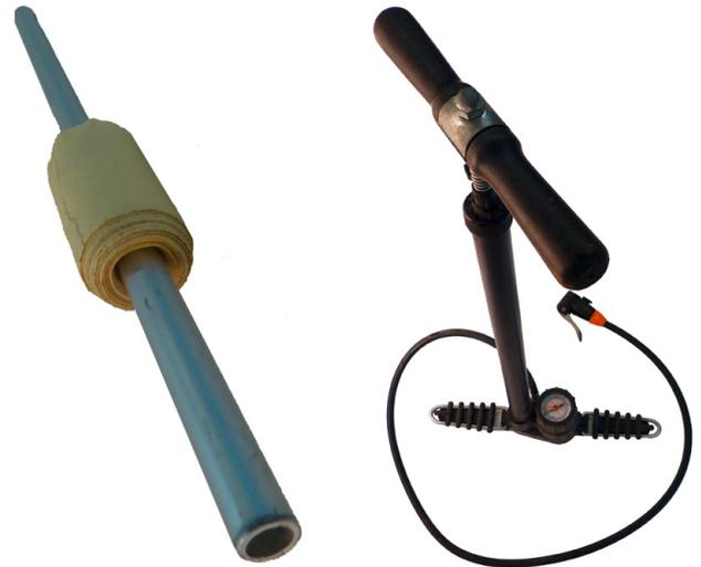
Abb. 252 | Der Zapfen und eine Standpumpe mit Druckanzeige
