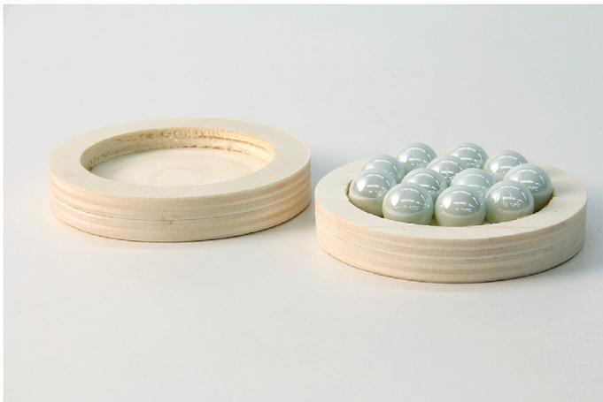
Abb. 164 | Kugellager aus Murmeln. Abgebildet ist eine Sperrholzversion.
