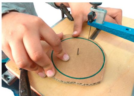
Abb. 156 | Sägehilfe für Räder (Bezug [www.do-it-werkstatt.ch](http://www.do-it-werkstatt.ch))
