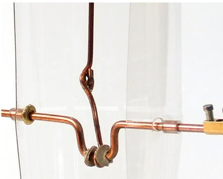
Abb. 202 | Schubstange mit Pleuel, geführt mit Kartonunterlagsscheiben
