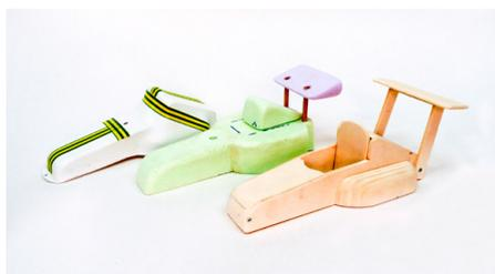
Abb. 175 | Karosserieentwicklungen mit Polystyrol (tiefgezogen), Polystyrolschaumstoff und Sperrholz
