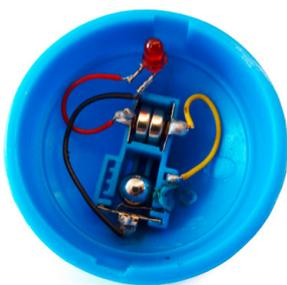
Abb. 139 | Analyse des Fliehkraftschalters eines Leuchtdiodenkreises
