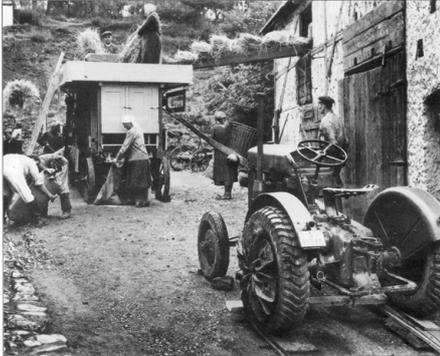
Abb. 113 | Erster serienmässig produzierter Kleinschlepper
