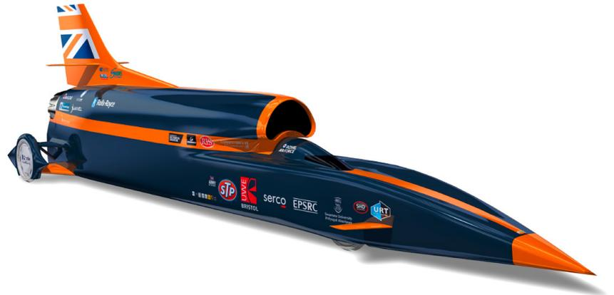
Abb. 13 | 4,5 Fußballfelder in einer Sekunde, 150 m in einem Wimpernschlag, schneller als eine Pistolenkugel, seine eigene Länge in weniger als drei Hundertstel einer Sekunde – der Bloodhound SSC soll über 1000 mph (1609 km/h) erreichen.
