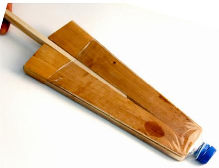
Abb. 283 | Flasche schrumpfen mittels Holzform und Heissluftföhn.
