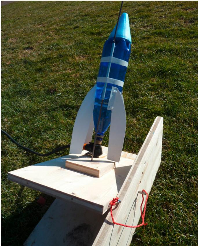
Abb. 254 | Beispiel einer PET-Rakete mit Spitze, Finnen und Gummizapfen
