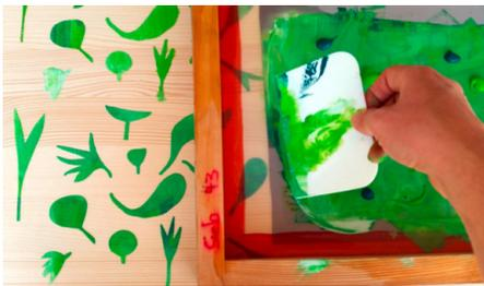
Abb. 47 | Mit einem Raker wird die Farbe durch die offenen Stellen gepresst.
