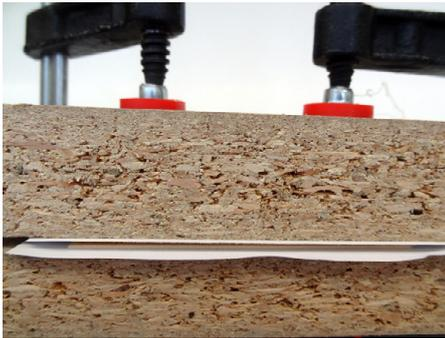
Abb. 170 | Die Schraubzwingen so positionieren, das der Pressdruck direkt auf den verleimten Furnierblättern liegt.
