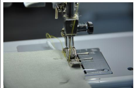
Naht mit Reissverschlussfuß möglichst nahe entlang der Garneinlage absteppen. Nadelposition entsprechend links ausrichten.
