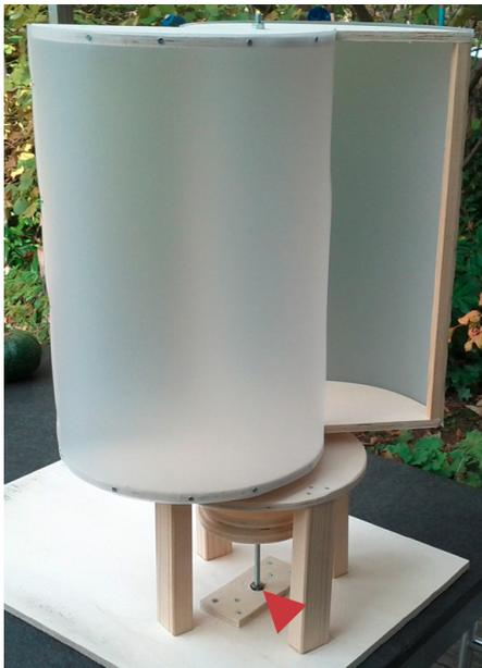
Abb. 274 | Savonius-Windrad mit Feststellschraube
