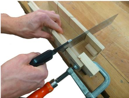
Abb. 148 | Ein Hilfsanschlag in der Gehrungsschneidelade führt beim Serienschritt zu gleich langen Holzteilen.
