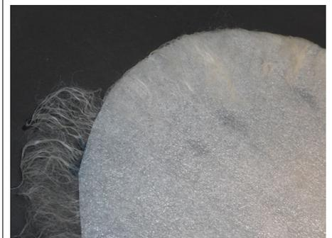
Die Schablonen werden mit mindestens drei Lagen belegt, immer wieder umgedreht, die überstehenden Fasern umgelegt usw. bis die gewünschte (berechnete) Filzdichte erreicht ist. Von nun an wird nur noch der Prozess der Lichtschale dokumentiert, da der Prozess für die Stimmungsluchte analog verläuft.
