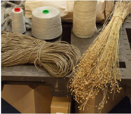
Abb. 238 | Nutzung der Flachsfaser: Flachsstroh, Flachsband und Leinengarn
