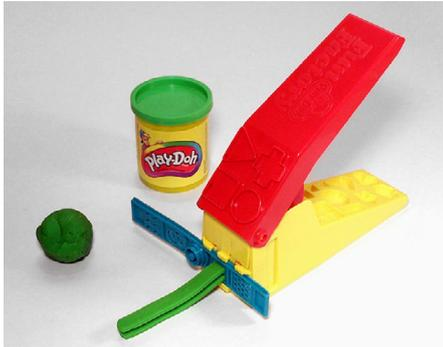
Abb. 103 | Kolbenextrusion von Knetmasse mit einem Kinderspielzeug
