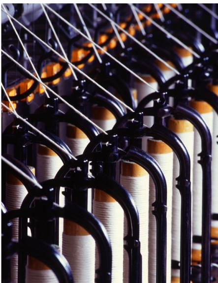
Abb. 60 | Flügelspinnmaschine
