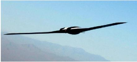
Abb. 155 | Das unbemannte Flugzeug Lockheed Polecat besteht zu einem Grossteil aus gedruckten Kunststoffbauteilen.
