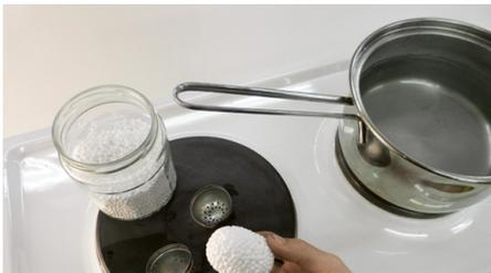
Abb. 31 | Nach einer ersten Trocknungsphase wird das vorgeschäumte Material in eine Stahl- oder Aluminiumform (hier ein Tee-Ei) gegeben. Die Form wird bis oben gefüllt und geschlossen. Nun wird über Düsen Dampf eingeblasen, der über andere Düsen wieder abgeführt wird. Durch die Hitze bläht sich das Material weiter auf. Es entsteht ein enormer Druck in der Form, und die Kügelchen verkleben zu einem grossen Block.
