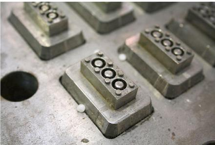
Abb. 102 | Unterseite eines LEGO-Spritzgusswerks
