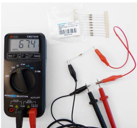
Abb. 137 | Widerstandsmessung an einem Widerstand
