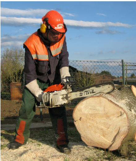
Abb. 211 | Motorsägenführer mit vollständiger Schutzausrüstung: Forsthelm, Wetterschutzjacke, Schnittschutzhose, Sicherheitstiefeln und Handschuhen.
