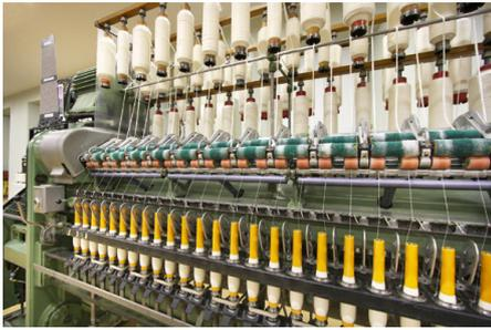
Abb. 61 | Ringspinnmaschine
