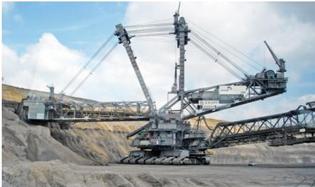
Abb. 189 | Der Schaufelradbagger 288 bei der Arbeit
