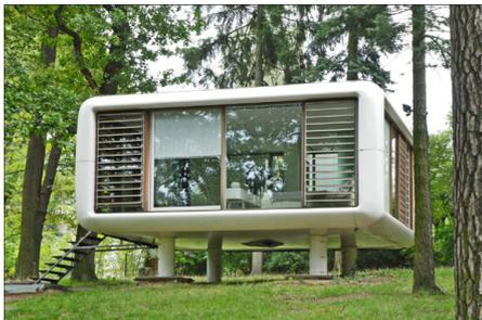
Abb. 284 | 2003 entwickelte der deutsche Designer Werner Aisslinger den Loft Cube – einen mobilen Wohnwürfel. Der Loft Cube bietet 39 m<sup>2</sup> und zieht mit seinen Bewohnenden um. Er kann bei Bedarf mit einem Kran oder einem Helikopter an den neuen Standort geführt werden.
