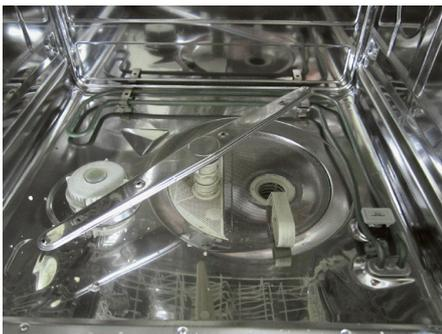
Abb. 247 | Hier wird gerade die Sprühdüse montiert.
