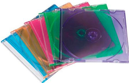
Abb. 33 | Viele Formteile aus Polystyrol werden im Spritzgiessverfahren hergestellt, z. B. CD-Hüllen. Kennzeichen ist ein kleiner Punkt, der als Ansatzpunkt der Einspritzdüse übrig bleibt und bei jedem Spritzgiessteil zu finden ist.
