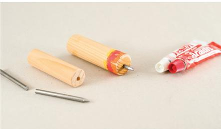
Abb. 119 | Der abgesägte Nagel wird tief in den Holzgriff steckt und geklebt.
