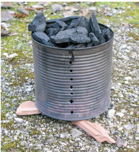
Abb. 131 | Die gefüllte Büchse wird auf die Distanzhalter gestellt. Sie sorgen für die Luftzufuhr.
