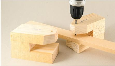
Abb. 161 | Mit der Bohrhilfe können Leisten rechtwinklig durchbohrt werden.
