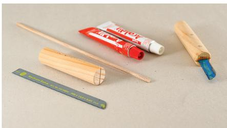
Abb. 120 | Das Sägeblatt wird mit einem Zweikomponentenkleber in den Griff geklebt.
