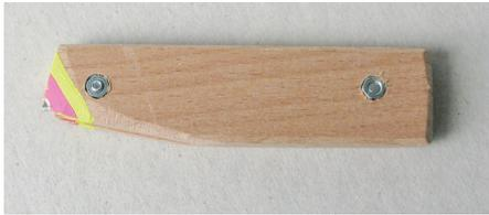
Abb. 121 | Der Kartoncutter ist so konstruiert, dass die Klinge kurz und fest verschraubt ist.
