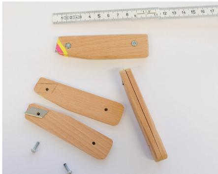
Abb. 122 | Die Spitze des Werkzeugs ist mit Farbe gekennzeichnet. Um ein Verrutschen der Klinge zu verhindern, wird eine flache Vertiefung in das Holz eingearbeitet.
