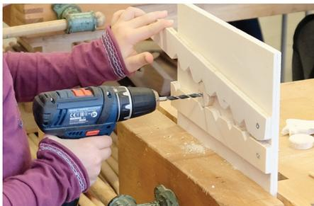
Abb. 164 | Die Räderklemme wird in der Werkbank eingespannt.
