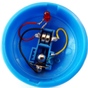
Abb. 139 | Analyse des Fliehkraftschalters eines Leuchtdiodenkreises
