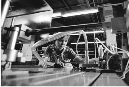
Abb. 270 | Der erste Nähroboter für die DDR-Textilindustrie wurde im Jahr 1980 in Betrieb genommen. Hier richtet eine Kleidungs-facharbeiterin den Nähroboter ein, der automatisch die Hosentaschen für Herrenhosen fertigt.
