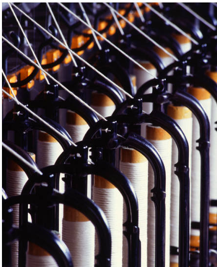
Abb. 273 | Vor dem Ringspinnen wird das Streckband auf der Flügelspinnmaschine (Flyer) zu einem Vorgarn, der Lunte, vorgespinnnen.
