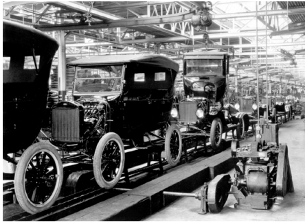
Abb. 239 | Autos wurden in den Fordwerken bis 1913 handwerklich produziert. Ein Jahr später gruppierte man alle Maschinen in der Reihenfolge der Bearbeitungsschritte. Dies verkürzte den Weg auf ein Zehntel. Die Bearbeitungszeit in der Endmontage wurde von 750 auf 93 Minuten verkürzt. Das Fließband war nur eine Konsequenz dieser Arbeitsorganisation.
