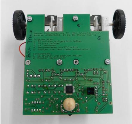
Abb. 160 | Der Microcontroller als Gehirn eines Roboters
