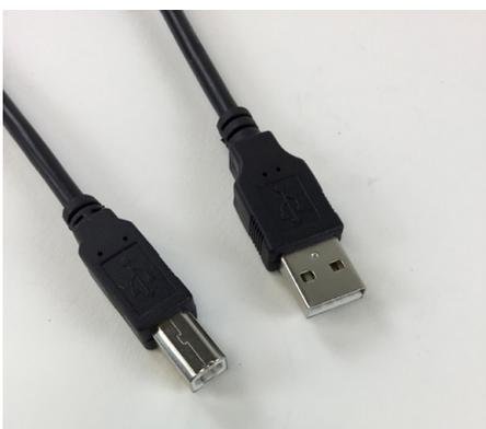
Abb. 170 | USB-Kabel mit Anschluss für den Computer und für den Arduino
