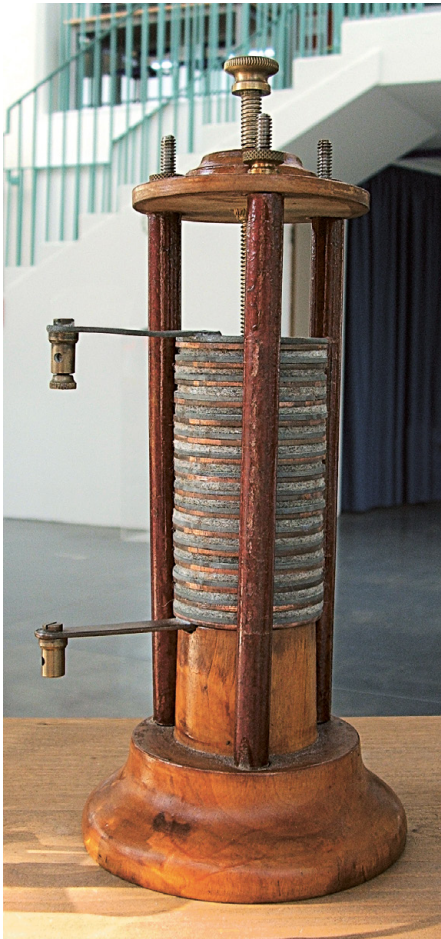
Abb. 92 | Nachbau einer voltaschen Säule. Zink- und Kupferplatten werden durch in Salzlösung getränkte Pappstücke getrennt. Verbindet man die beiden Endplatten miteinander, fließt Strom.
