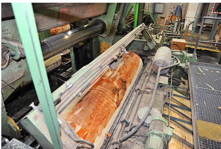
Abb. 02 | Die Stämme werden von der Rinde befreit und anschliessend aufgesägt.
