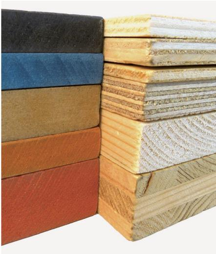
Abb. 04 | links: MDF-Platten sind in verschiedenen Farben erhältlich. rechts: Sperrholz und Dreischichtplatten. Charakteristisch sind die verschiedenen sichtbaren Furniere, die kreuzweise verleimt wurden.
