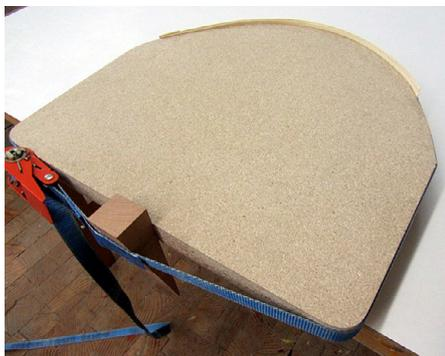
Abb. 171 | Einfache Lehre mit einem Spanngurt
