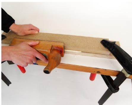
Abb. 168 | Wichtig: Das Furnier und die Platten müssen unten bündig sein.
