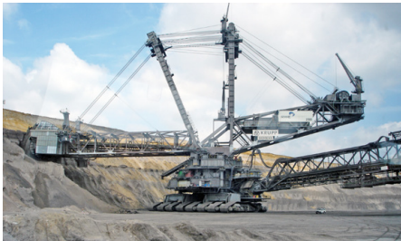
Abb. 189 | Der Schaufelradbagger 288 bei der Arbeit
