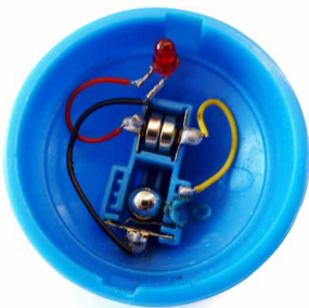
Abb. 118 | Analyse des Fliehkraftschalters eines Leuchtdiodenkreises
