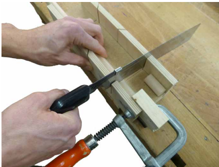
Abb. 127 | Ein Hilfsanschlag in der Gehrungsschneidelade führt beim Serienschritt zu gleich langen Holzteilen.
